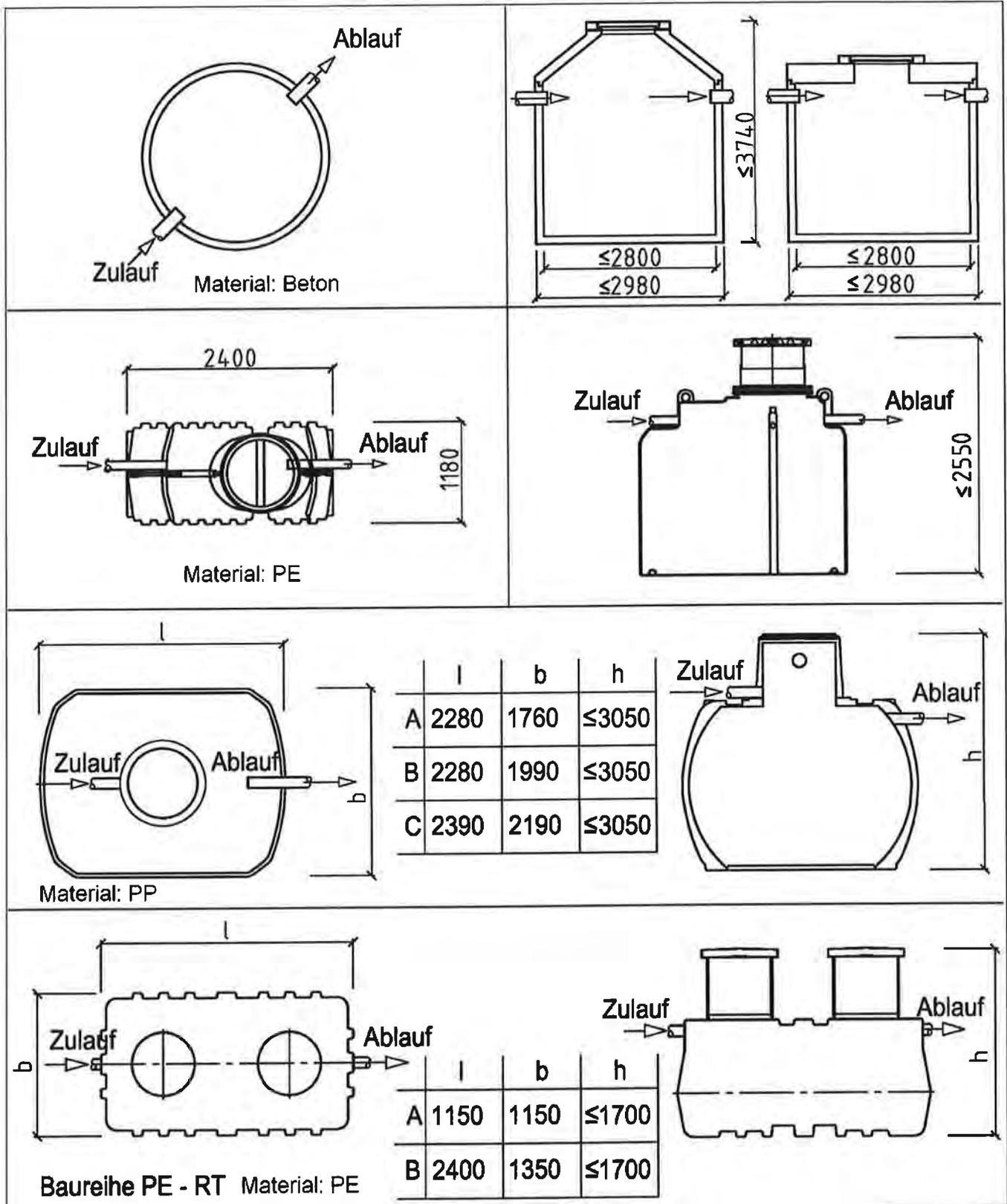
Anwendungsbestimmungen für Kleinkläranlagen nach DIN EN 12566-3 mit CE-Kennzeichnung: SBR-Anlagen Typ klärofix D / klärbox D aus Beton, PE oder PP, Ablaufklasse D
