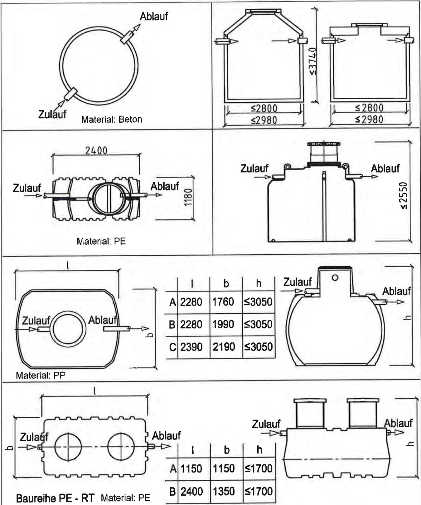
Anwendungsbestimmungen für Kleinkläranlagen nach DIN EN 12566-3 mit CE-Kennzeichnung: SBR-Anlagen Typ klärfix N / klärbox N aus Beton, PE oder PP, Ablaufklasse N
