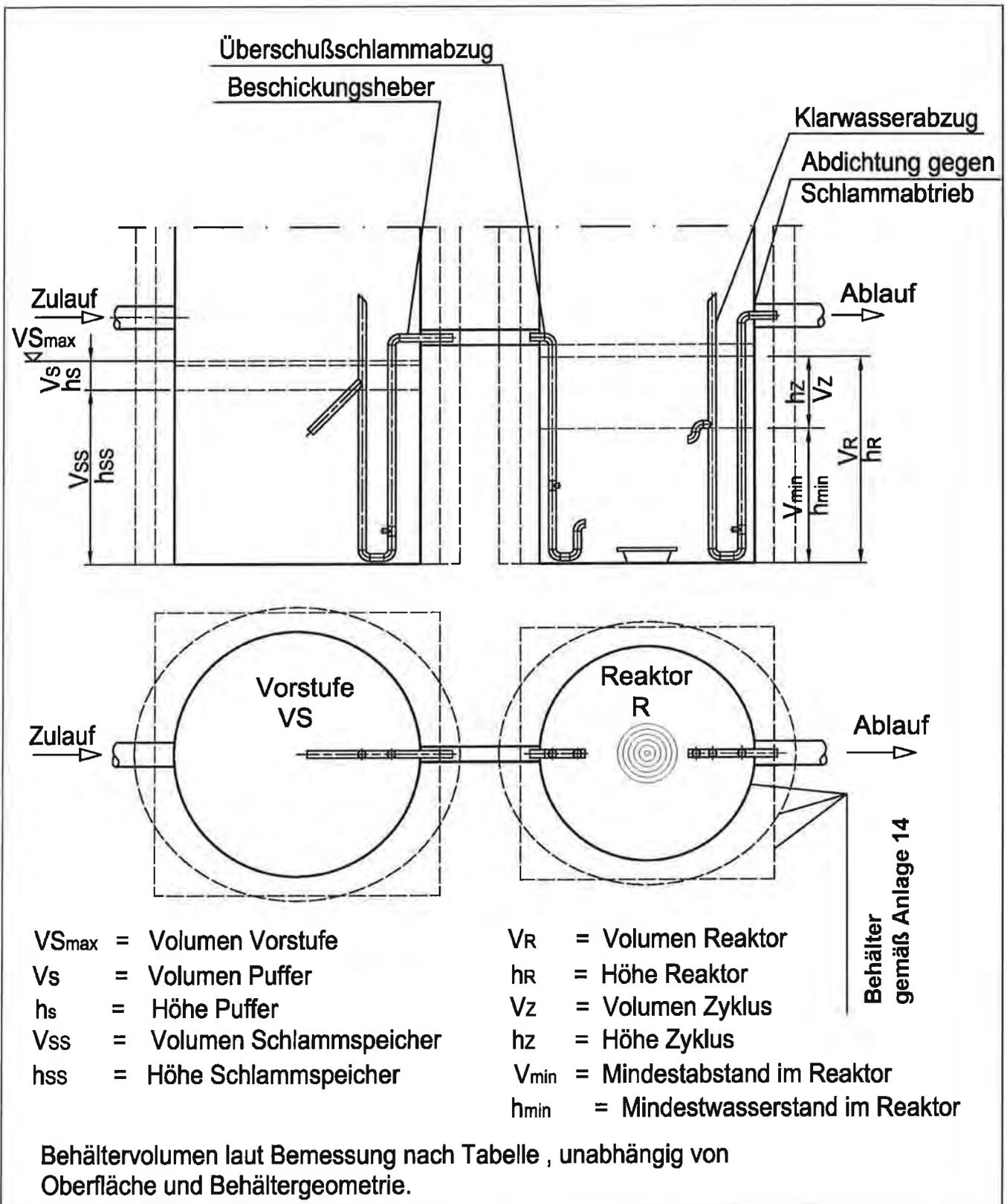
Anwendungsbestimmungen für Kleinkläranlagen nach DIN EN 12566-3 mit CE-Kennzeichnung: SBR-Anlagen Typ klärofix N / klärbox N aus Beton, PE oder PP, Ablaufklasse N
