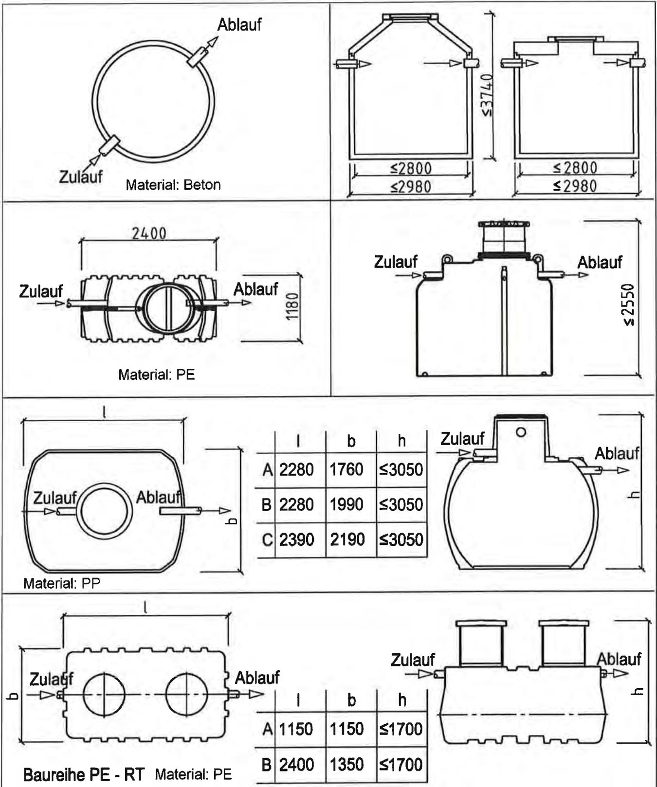
Anwendungsbestimmungen für Kleinkläranlagen nach DIN EN 12566-3 mit CE-Kennzeichnung. SBR-Anlagen Typ klärofix / klärbox aus Beton, PE oder PP, Ablaufklasse D+H
