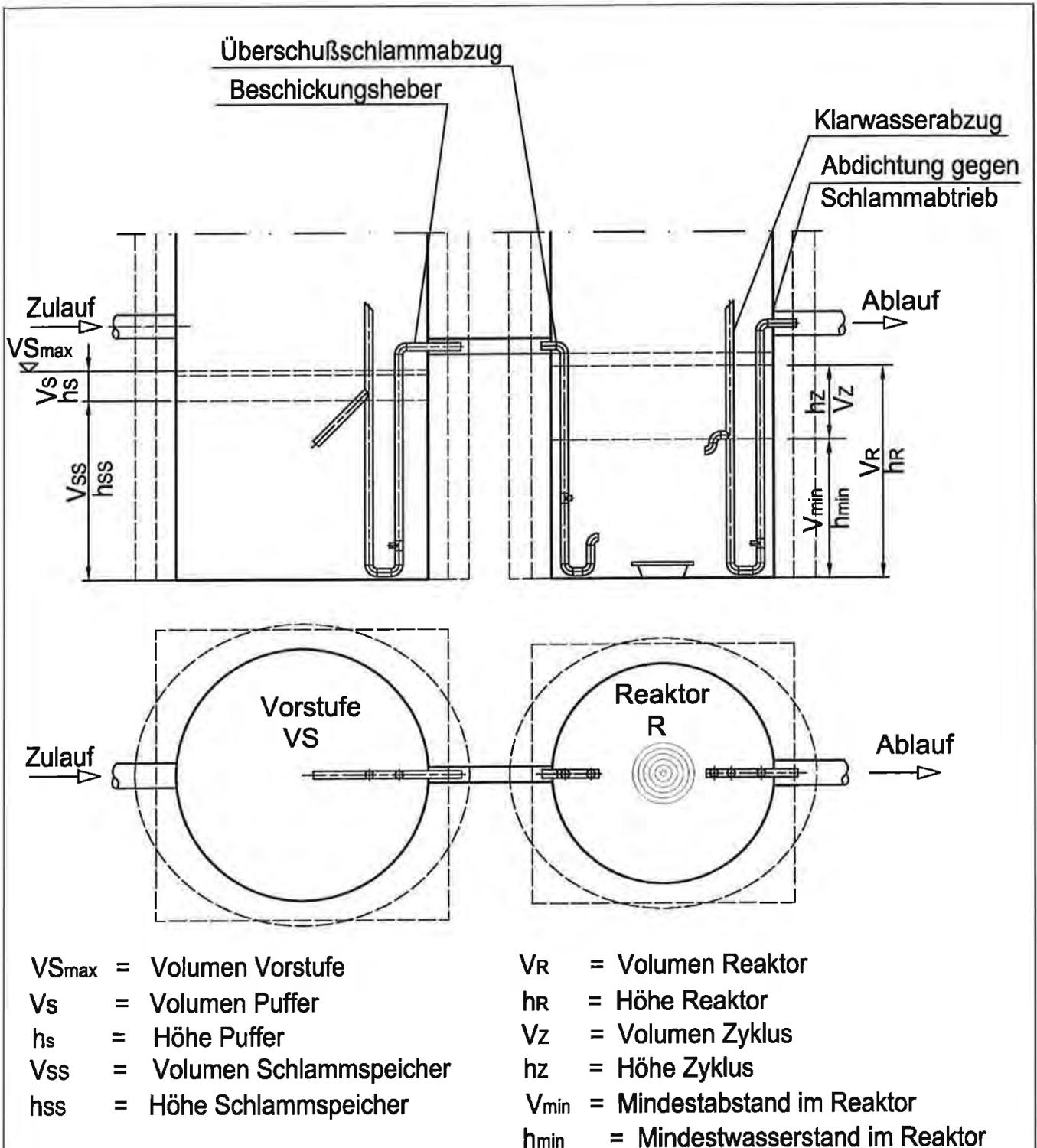
Behältervolumen laut Bemessung nach Tabelle , unabhängig von Oberfläche und Behältergeometrie.
